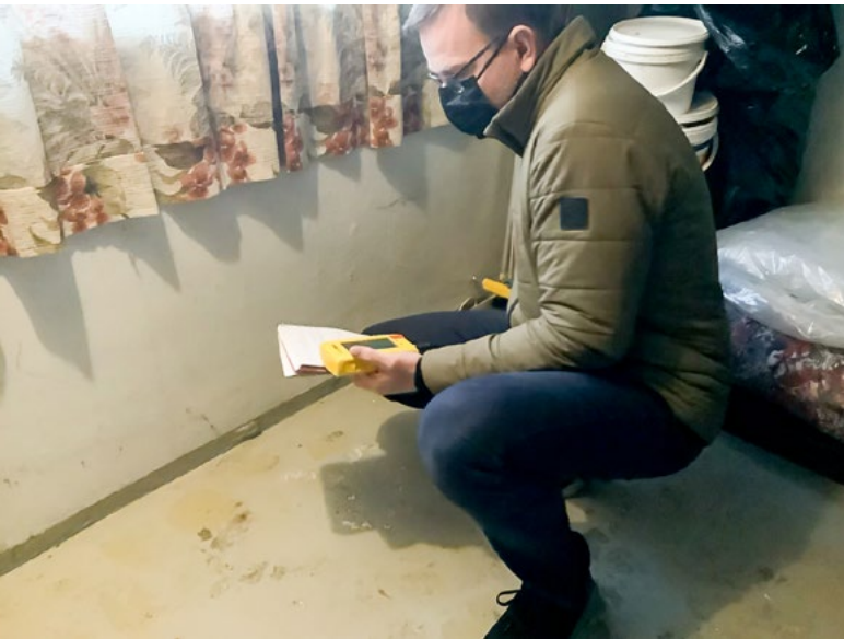
10. mynd. Rakamæling í útvegg vegna húsnæðisskoðunar.
