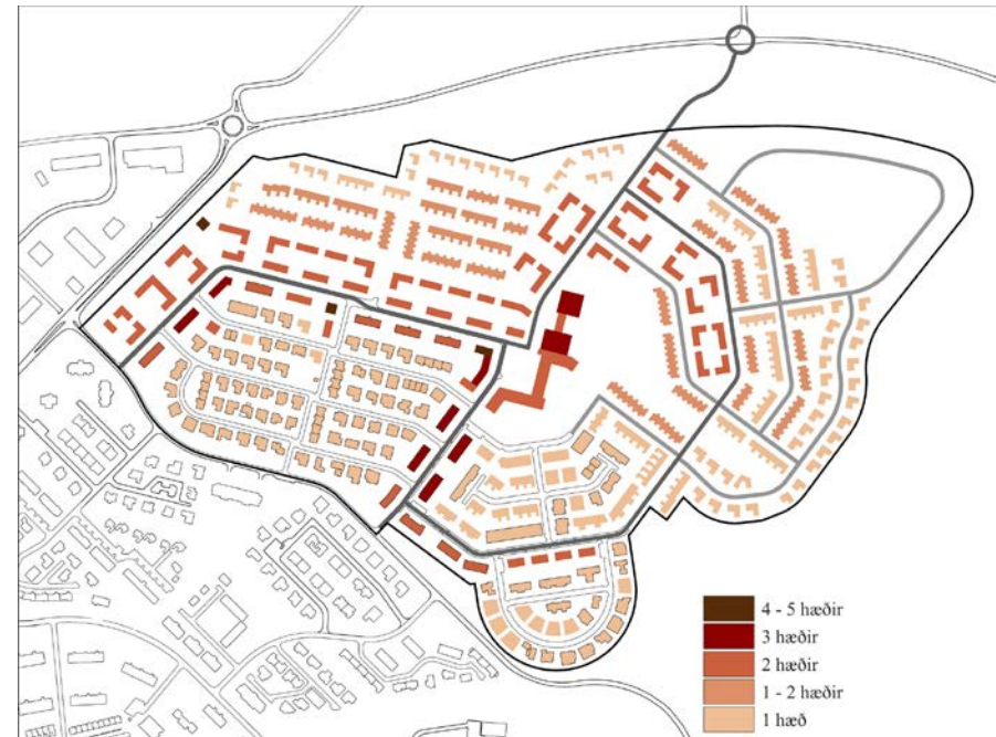
Mynd 12. Byggðamynstur, hæð húsa
